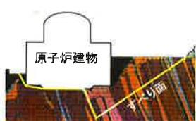
$$\text{すべり面上のせん断抵抗力} \\ \text{すべり安全率 } F_s = \frac{\text{すべり面上のせん断力}}{\text{すべり面上のせん断力}}$$
