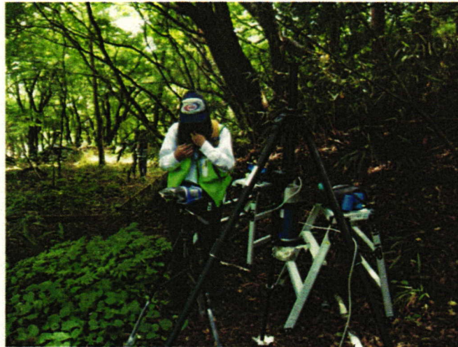
図 2 - 5. 山林内での放射線波高分布の測定風景
